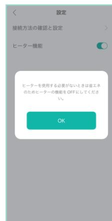
ヒーター機能のスライドボタンをタップするとヒーター機能が有効になり0°C以下を検出したとき自動的にヒーターが作動します。
