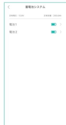
ホーム画面上のシステム詳細アイコン (e) をタップするとシステムに組み込まれているバッテリーの一覧が表示されます。
